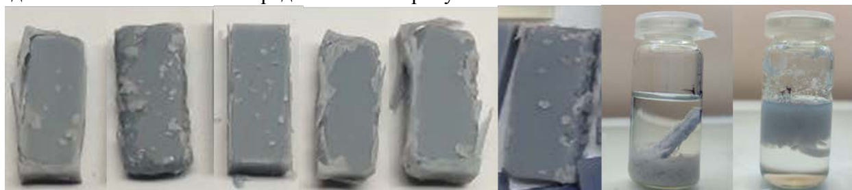
Рисунок 1. Изменения изделий в органических растворителях (слева направо): в метиэтилкетоне, 1,2-дихлорэтано, диметилформамиде, ацетоне, ацетонитриле, уксусной кислоте, муравьиной кислоте и хлороформе)
